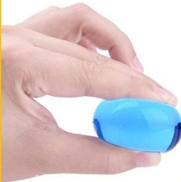
Водопоглощающая смола с круглыми шариками сокращенно обозначается как водопоглощающий шарик, который представляет собой разновидность высокомолекулярного полимера с материалом на основе натрия с сильными гидрофильными группами, который сшивается, образуя сетчатую структуру.
