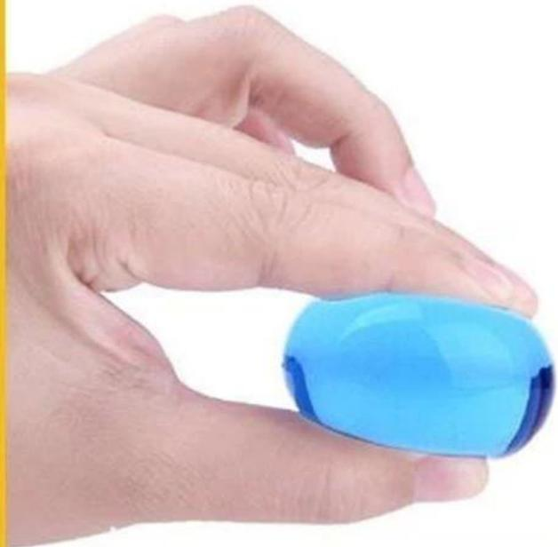
La resina assorbente d'acqua di tipo a perline tonde è abbreviata come perlina assorbente d'acqua, che è una sorta di polimero ad alto peso molecolare con un materiale a base di sodio con forti gruppi idrofili che è reticolato per formare una struttura a rete.
